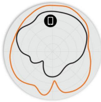
Abbildung 4. H350 2,4 GHz-Elevation-Antennenmuster
