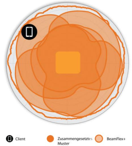
Abbildung 2. H350 2,4 GHz-Azimuth-Antennenmuster
