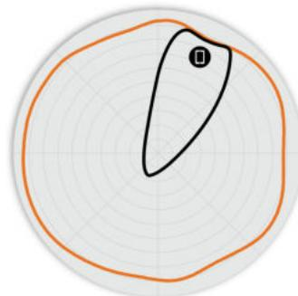
Abbildung 5. H350 5 GHz-Elevation-Antennenmuster
