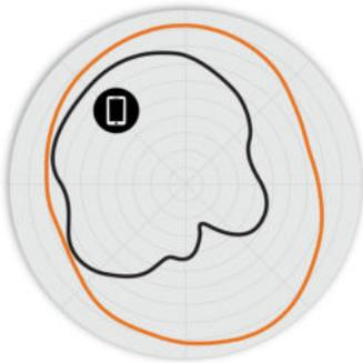
Abbildung 3. H350 5 GHz-Azimuth-Antennenmuster
